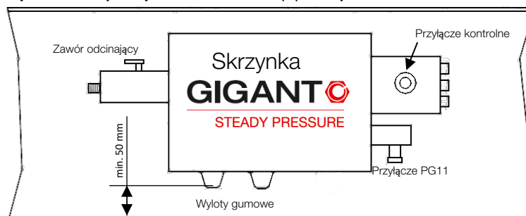
Przykładowa ilustracja: Skrzynka sterownicza na belce poprzecznej
