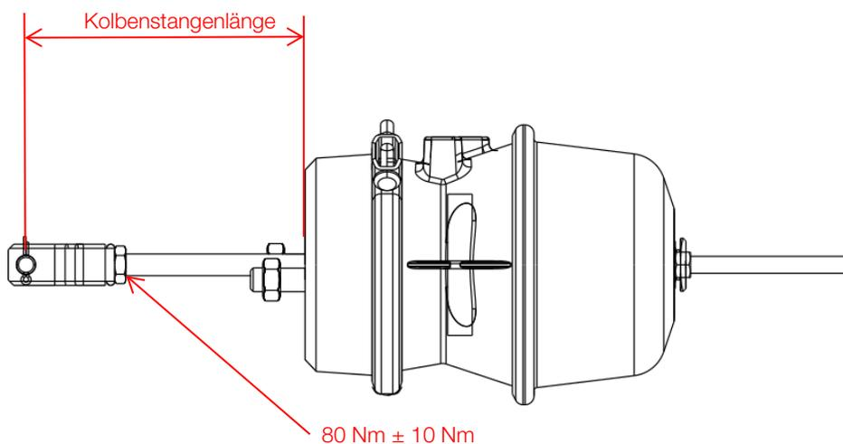
Die Kontermutter des Gabelkopfs nach Einstellung der Kolbenstangenlänge mit 80 Nm ± 10 Nm anziehen.
