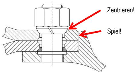
**Hinweis:** Bolzenzentrierte Felgen dürfen nur an Achsen, die auf Bolzenzentrierung ausgelegt sind, verwendet werden.
