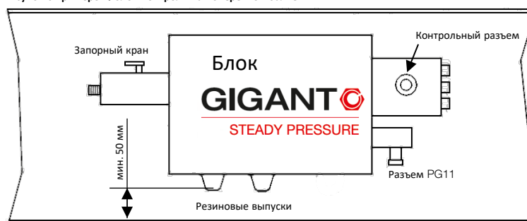
Рисунок с примером: блок контроля на поперечной балке
