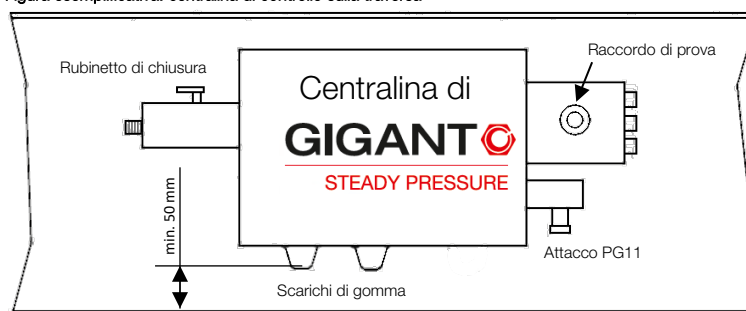
Figura esemplificativa: centralina di controllo sulla traversa
