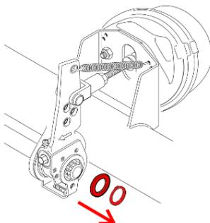
3. Verschleißanzeiger mit der Verlängerung nach oben vertikal aufstecken und mit Sicherungsring sichern
