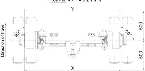
Toe - in:  $X - Y = 5 \pm 1 \text{ mm}$
