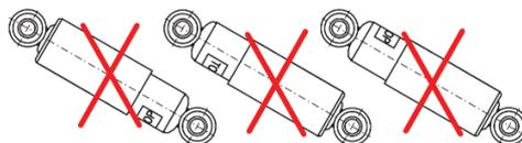
El amortiguador siempre se monta con el tubo protector en la integración superior del amortiguador.
