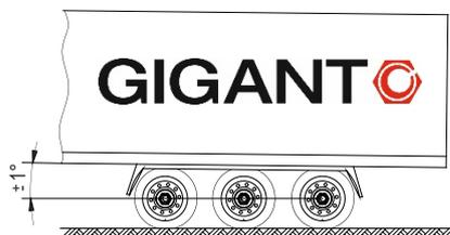
L'inclinaison maximale de la carrosserie de la semi-remorque ne doit pas dépasser  $\pm 1^\circ$  ou 20 mm/m !
