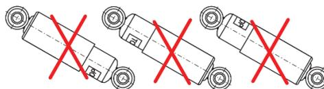
Der Stoßdämpfer wird immer mit dem Schutzrohr an der oberen Stoßdämpferbefestigung montiert.
