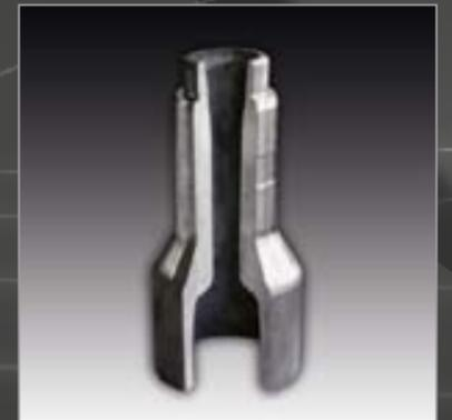
Der Achskörper mit dem Lagersitz besteht aus einem Stück, was die sonst kritische Schweißung am Achsstummel vermeidet. Der gesamte Achskörper weist einen ununterbrochenen Materialfaserverlauf auf. Daraus resultiert eine bestmögliche Auslegung auf Biege- und Torsionsbeanspruchungen sowie eine höchstmögliche Sicherheit gegen Achsbrüche.
