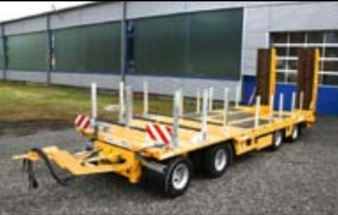
Die Tiefladerachse GKH2 3020 ist als starre Achse für Reifengrößen von 15 Zoll bis 19,5 Zoll ausgelegt. Sie ermöglicht sehr **niedrige Bauhöhen** bei Achslasten von 10,5 t bis 12 t.
