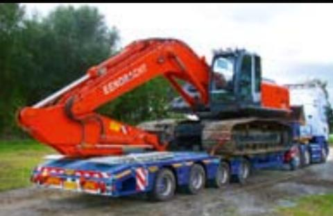
Die Gigant GZK2 3020 ist eine Tiefladerachse mit Zwangslenkung, ausgelegt für Achslasten von 10,5 t bis 12,0 t. Die GZK2 3020 lässt sich für **alle gängigen Lenksysteme adaptieren**.
