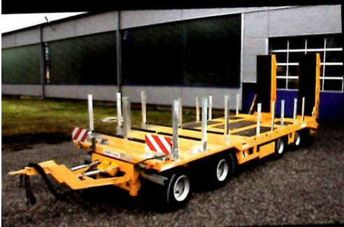
L'essieu pour remorque surbaissée GKH2 3020 est conçu comme un essieu rigide pour une dimension de pneu comprise entre 15 et 19,5 pouces. Il permet des **hauteurs de montage très faibles** pour les charges d'essieu comprises entre 10,5 t et 12 t.
