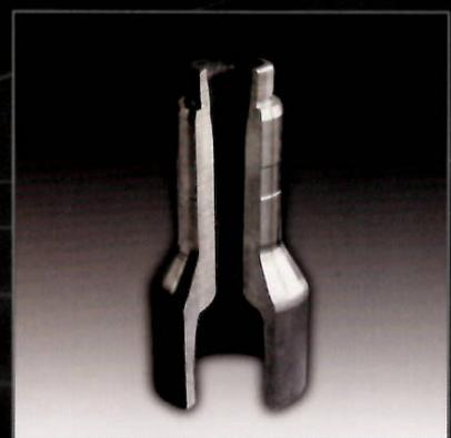
Le corps de l'essieu avec le siège de palier se compose d'une seule pièce, ce qui évite le soudage sinon critique sur la fusée d'essieu. La totalité du corps d'essieu présente un fibrage du matériau continu. Il en résulte une conception optimisée aux sollicitations de flexion et de torsion ainsi qu'une sécurité optimale contre les ruptures de l'essieu.
