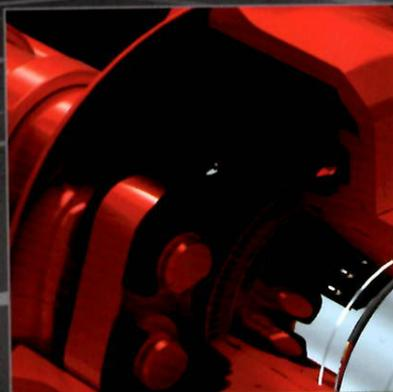
Les essieux pour charge lourde avec frein à tambour de Gigant sont équipés du frein à tambour PROTEC éprouvé et simple d'entretien. Un des avantages particuliers est que la plaquette de frein peut être remplacée en quelques secondes sans utiliser d'outil spécial.
