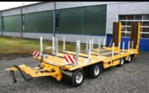
Мост для низкорамных прицепов GKH2 3020 представляет собой неразрезную конструкцию для колес размером от 15 до 19,5 дюймов. Это обеспечивает **очень низкую высоту прицепа** при нагрузке на ось 10,5–12 т.
