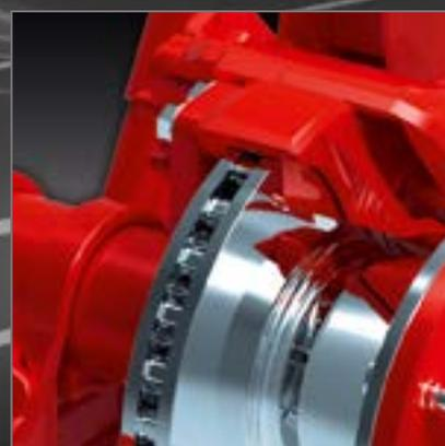
Неразрезной мост для низкорамных прицепов и подруливающий мост для колес размером 19,5" теперь также предлагаются с дисковыми тормозами. При использовании шин размером 255/60 R19,5 это обеспечивает такую же конструктивную высоту, что и для моста на 17,5 дюймов. Преимущества: большая несущая способность, меньший износ.
